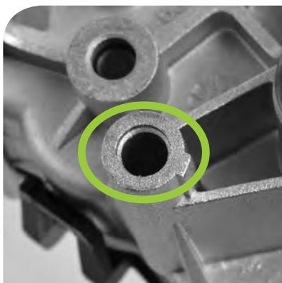
1 - Der Ersatzmotor hat kein Gewinde im Durchgangsloch.
